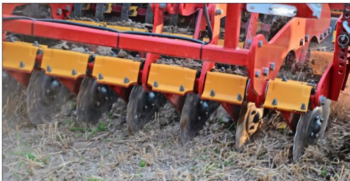
Rapid RD300S von Väderstad: Die Saatgutablage auf 6–7 cm erfolgt hinter den Scheiben. Die Maschine eignet sich für Mulch- und Direktsaat.
