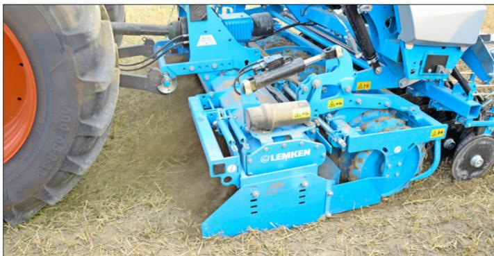
8 cm tief wird der Boden hier von der Lemken-Kreiselegge bearbeitet. Jede Schar der Saphir 9 ist mit einer Andruckrolle zur Rückverfestigung versehen.
